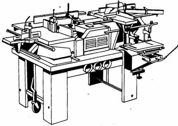
Ein meisterliches System für den Profi. Die variable Kombinationsmaschine für die Holzbearbeitung mit hoher Präzision und Leistungsfähigkeit zum Sägen, Abrichten und Dickenhobeln, Fräsen und Langlochbohren.
