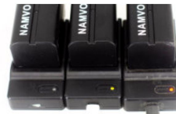
Akkus in der Ladeschale, wobei links schon die Steckerbuchse defekt ist und diese Lademöglichkeit somit ausfällt.
